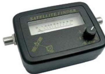
Le problème est que le SATFINDER est fait pour orienter une parabole vers un satellite de TV, il permet donc une détection du satellite et non une mesure de son rayonnement. En général l'aiguille bascule très vite du 2 vers le 10, or nous cherchons à mesurer le rayonnement solaire...
